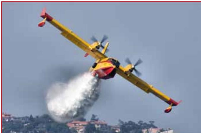
A l'aide d'un interrupteur manuel incorporé au levier de commande, le pilote peut déclencher l'ouverture des trappes en simultané, une fois ou en séquence.
