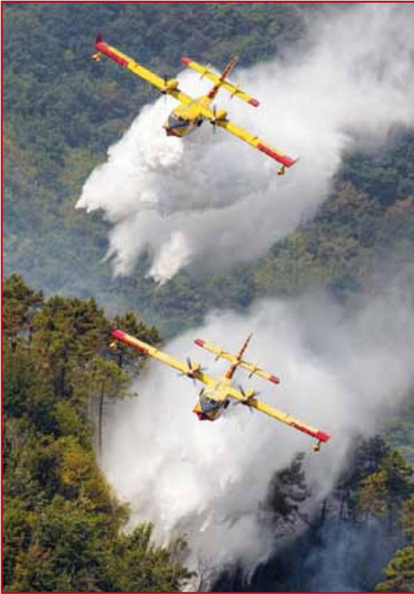
des réservoirs pendant que l'avion rase la surface de l'eau. Un simple clapet à battant empêche l'eau de ressortir. Des raccords de tuyaux situés de chaque côté du fuselage permettent de remplir les citernes au sol.
